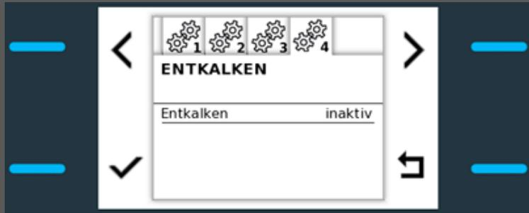
Im Menü können unter dem Reiter Dosiertechnik die Entkalkungszeiten und –temperatur angepasst werden.
